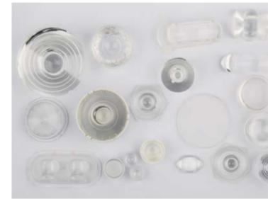
2. 光学部件的选择：根据产品类型的不同，为光学部件选择合适的材质及形式，如光学级 PC/PMMA 透镜（TIR/菲涅尔）及透光罩/透光柱、导光柱/导光管、镀膜钢化玻璃、微结构光学膜等等。即使是相同的材质，也会因为光学和防护设计要求而进行针对性的工艺处理，如镀膜、磨砂、蚀刻，以及普遍的防 UV 老化处理和防盐雾设计（暴露在灯体表面部分）。
