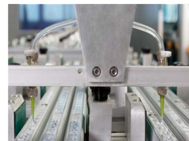
4. 材质、生产工艺：根据不同的照明应用类型选择照明产品各部件及配件的材质，如压铸铝（泛光灯 / 投光灯系列）、挤压铝型材（洗墙灯 / 擦墙灯系列、线形像素灯及各种安装型材）、不锈钢（各种安装支架）、PC/PMMA/工程塑胶（光学部件、壳体、端盖）、钢化玻璃（透光罩）。表面处理和防护措施也充分考虑外观及安规要求（色泽均匀、耐高温、防盐雾、结构或灌胶防水等）而选择能满足户外长期使用的工艺。
